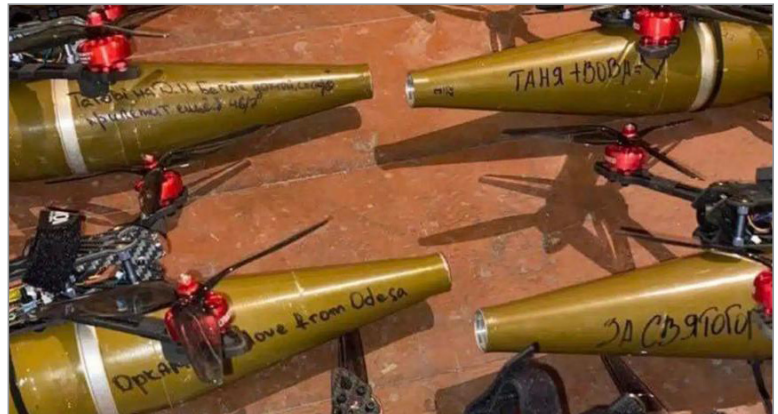
<그림 3> 우크라이나가 근접전투시 사용하는 RPG-7탄을 장착한 FPV 자폭드론
