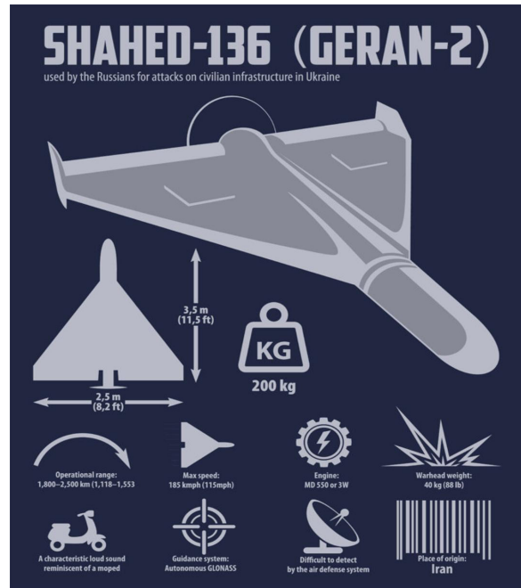
<그림 1> 우-러 전쟁에서 러시아가 사용하고 있는 Shahed-136 드론 출처 : https://defencesecurityasia.com/en/shahed136-suicide-drone-iran/
